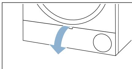
3. Deblocați mânerul capacului schimbătorului de căldură.
