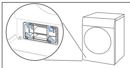
4. Trageți de mânerul capacului schimbătorului de căldură.
