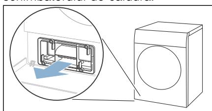
5. Trageți cu atenție filtrul de la capacul schimbătorului de căldură.
