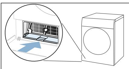
**10. Apăsați mânerul capacului schimbătorului de căldură.**
