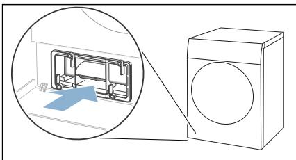
**Indicație:** Capacul schimbătorului de căldură poate fi apăsat numai dacă acesta se află în aparat.
