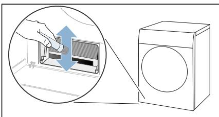
**Indicație:** În timpul curățării, aveți grijă să curătați lamelele schimbătorului de căldură de sus în jos și să nu le îndoiați sau deteriorați.
