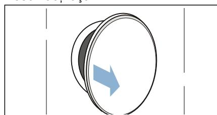
2. Curătați senzorul de umiditate cu un burete aspru.
